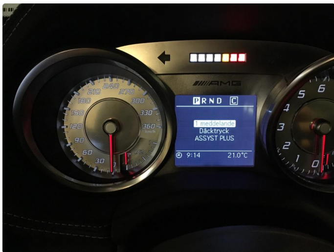
2.4 Dekk trykk varsel , feil ved system
