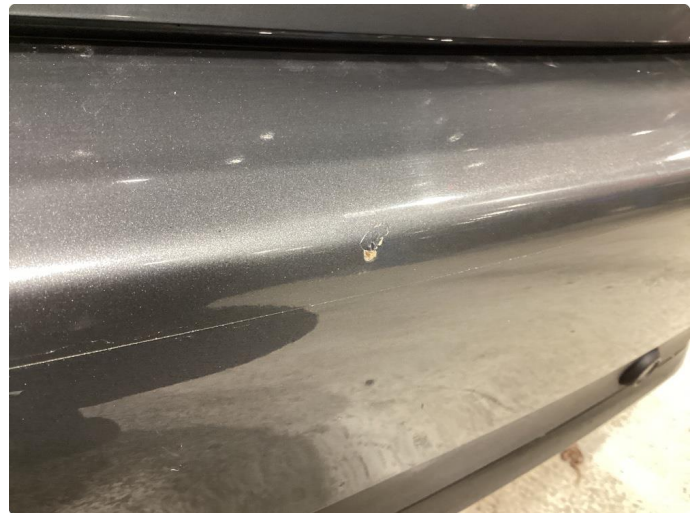
1.2 Bruksmerke på støtfanger bak
