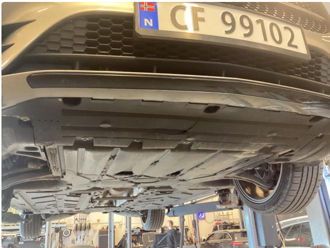
1.1 Liten ubetydelig skade på beskyttelsesplate
