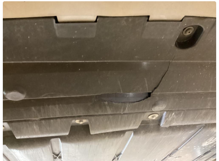
1.1 Liten ubetydelig skade på beskyttelsesplate
