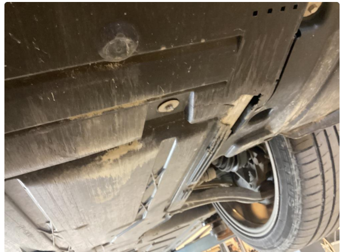
1.1 Liten ubetydelig skade på beskyttelsesplate
