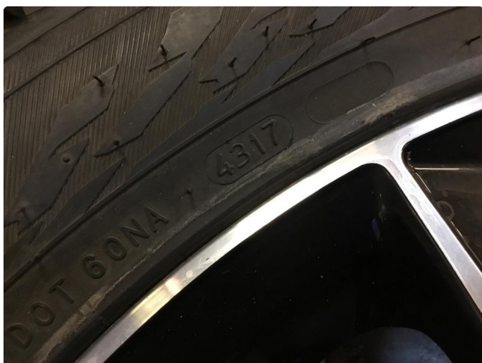
1.2 Eldre dekk fra 2018, manglende pigger
