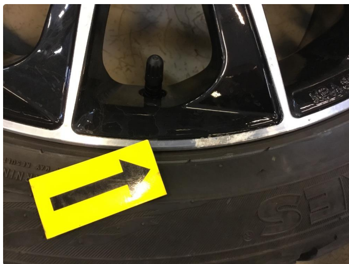
1.3 Oksidering på vinterfelger, samt noe av felgene er kantkjørte
