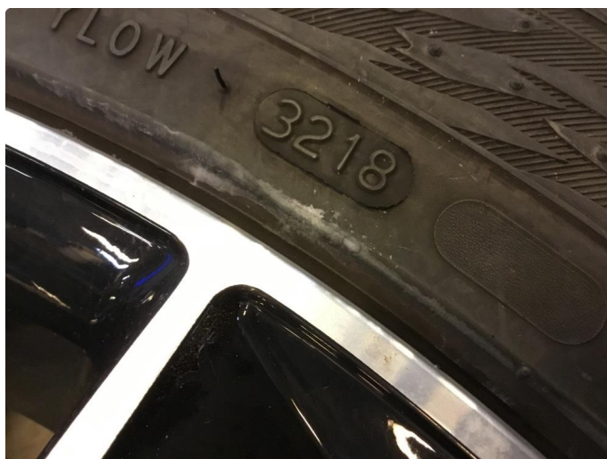
1.2 Eldre dekk fra 2018, manglende pigger
