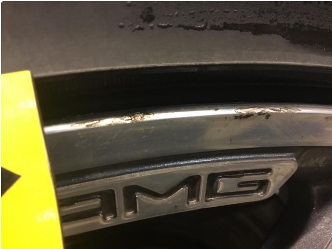
1.1 Noe mindre kantkjøringsskader på 2stk sommerfelger.
