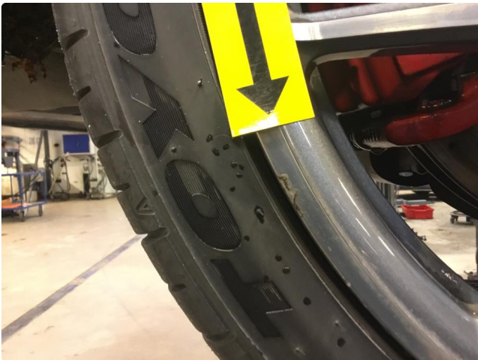
1.1 Noe mindre kantkjøringsskader på 2stk sommerfelger.
