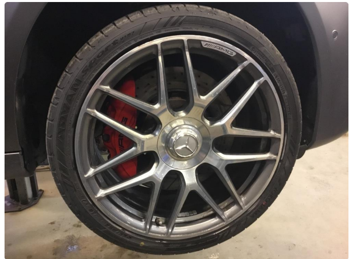
1.1 Noe mindre kantkjøringsskader på 2stk sommerfelger.
