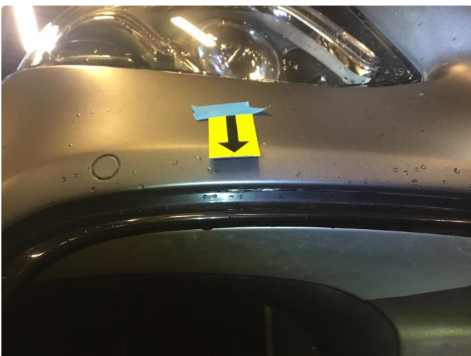
1.2 Noe slipp av folie under kant fanger foran.
