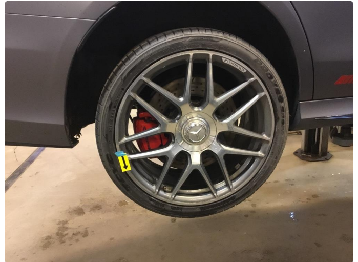
1.1 Noe mindre kantkjøringsskader på 2stk sommerfelger.
