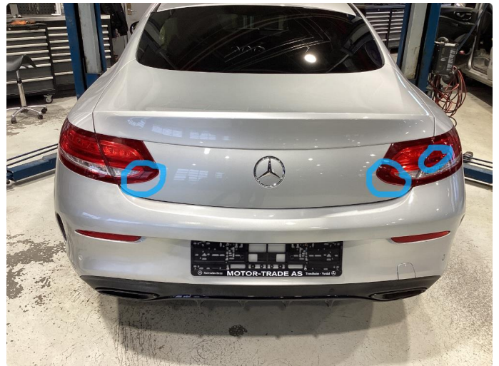
2.1 Ubetydelig krakelering i plast, normal etter alder
