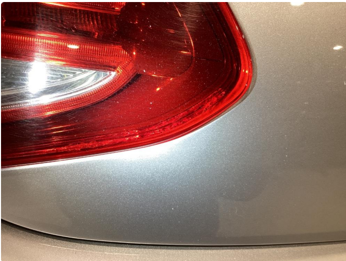
2.1 Ubetydelig krakelering i plast, normal etter alder
