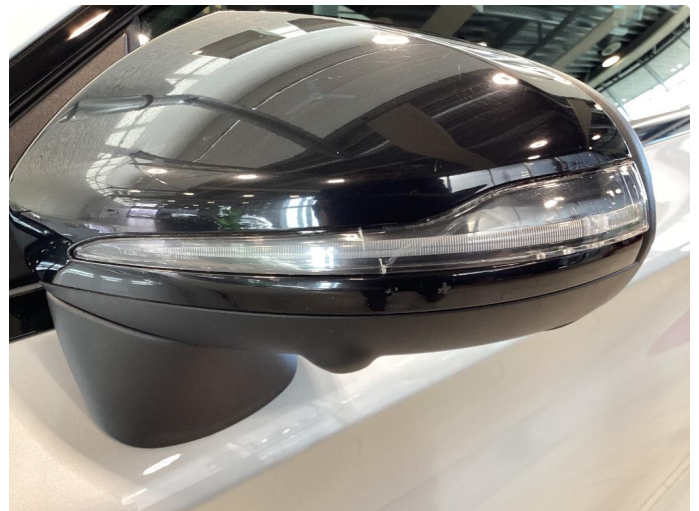
2.2 Litt krakelering i plast, normalt etter alder
