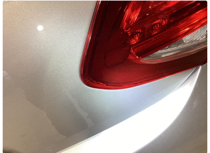
2.1 Ubetydelig krakelering i plast, normal etter alder
