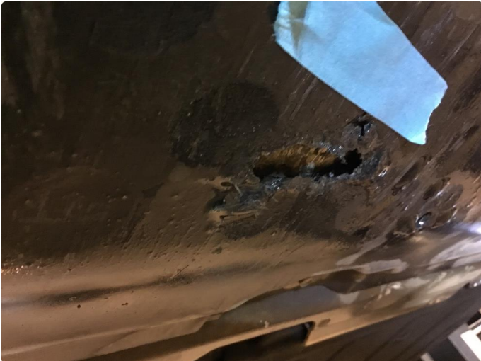
1.2 Noe skader på plastplater under bil.
