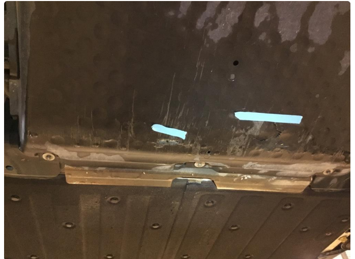
1.2 Noe skader på plastplater under bil.
