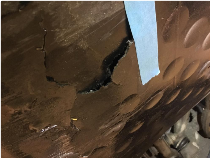
1.2 Noe skader på plastplater under bil.
