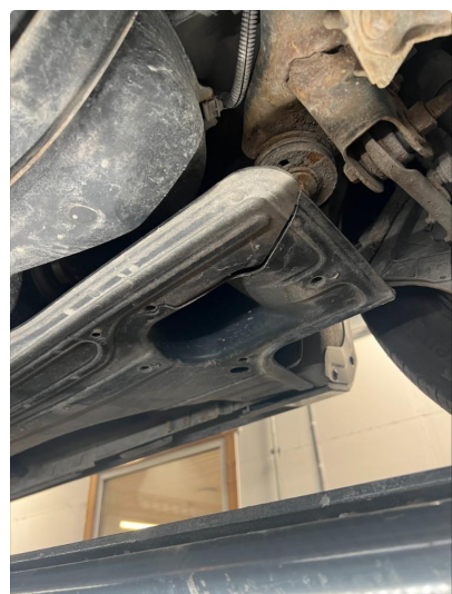
1.2 Stedehvis noe overflaterust under bilen.
