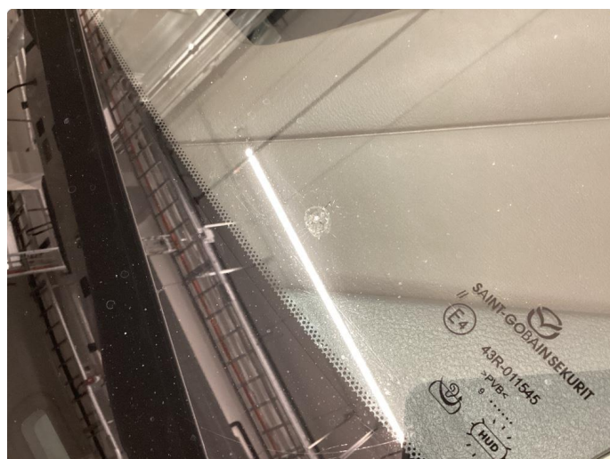
1.6 Steinsprut med sprekk utenfor synsfelt
