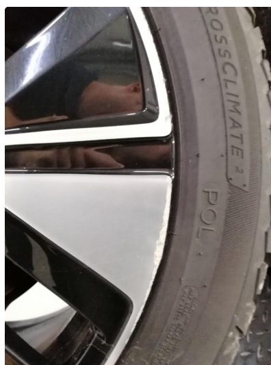
1.1 Skrape i felg (reparert)
