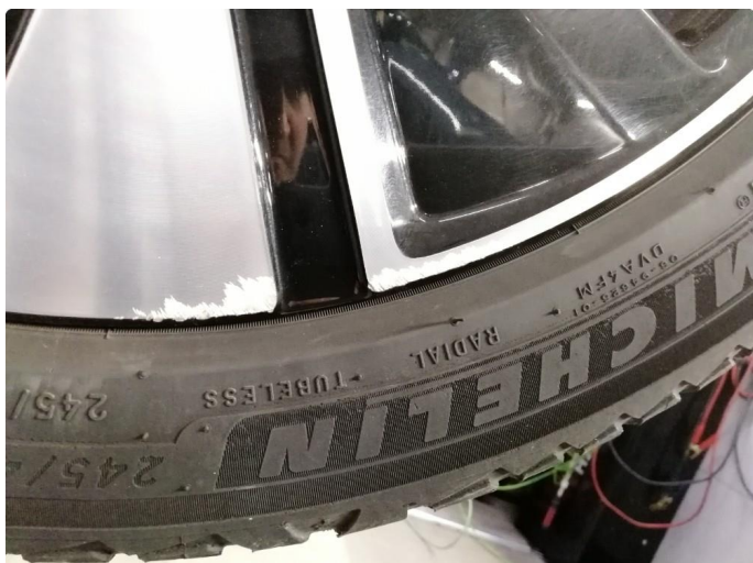
1.1 Skrape i felg (reparert)
