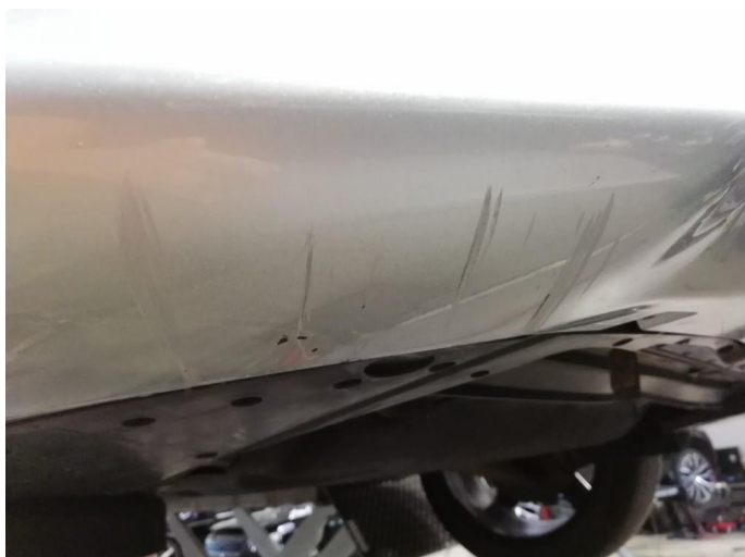
1.1 Liten skrubbskade underkant fanger, ubetydelig
