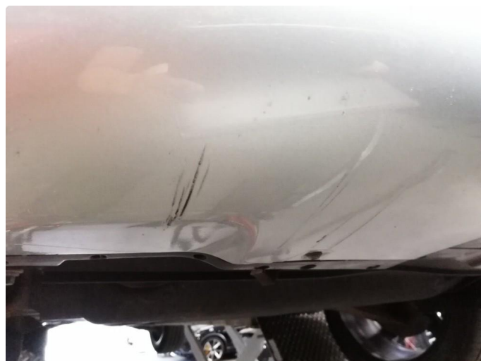
1.1 Liten skrubbskade underkant fanger, ubetydelig
