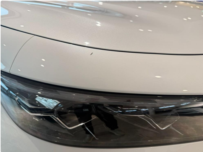
1.1 Lite hakk / Steinsprang høyre side av panser/forskjerm.
