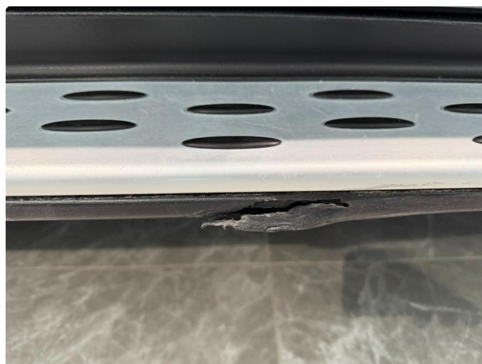
1.4 Liten skade på høyre stigtrinn, se bilde.
