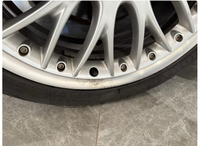
1.2 Litt korrodering på høyre bak - sommerfelg.
