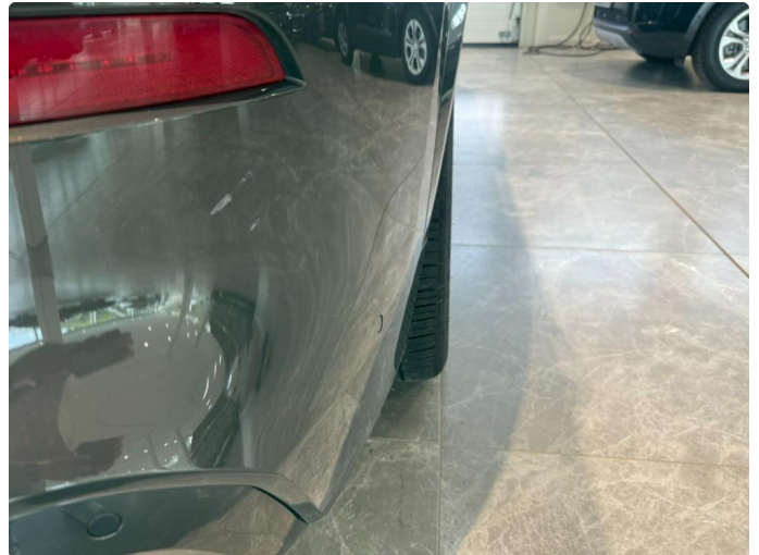
1.4 Liten skrape støtfanger.
