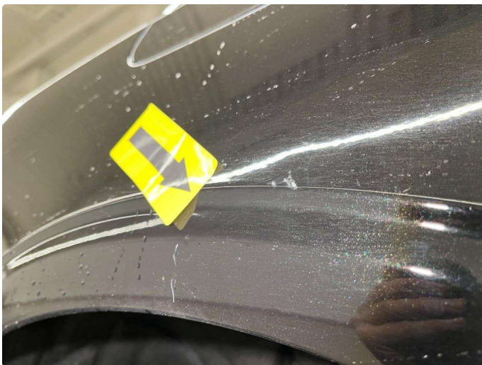
1.1 Noen bulker med lakkskader
