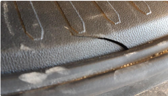
1.1 Liten sprekk i plastikk (bagasjeromsåpning)
