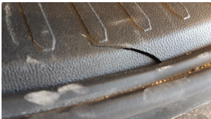
1.1 Liten sprekk i plastikk (bagasjeromsåpning)
