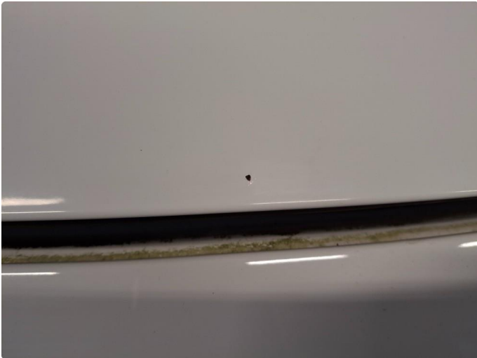
1.1 Noe steinsprut, normal bruksslitasje.
