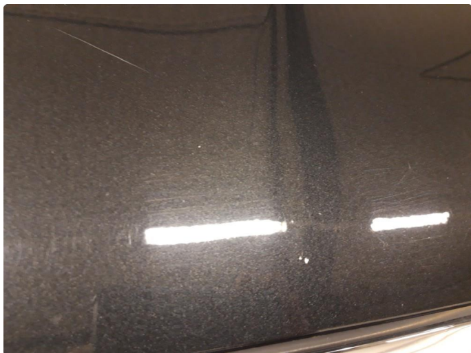
1.1 Noen få steinsprut på panseret
