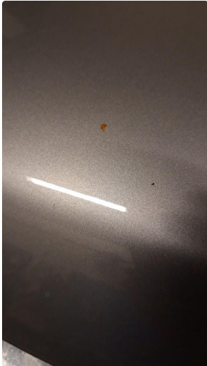
1.1 Litt steinsprut, blir pusset og lakkert med steinsprut lakk før levering
