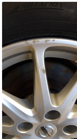
1.1 1stk felg har noen skaper/kantkjørt
