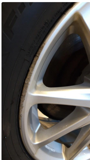
1.1 1stk felg har noen skaper/kantkjørt
