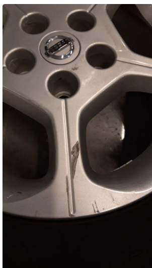
1.1 1stk felg har noen skaper/kantkjørt
