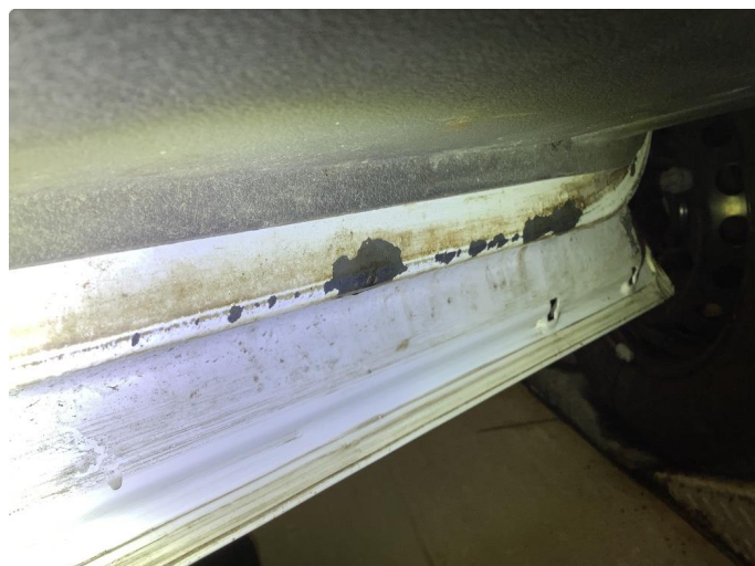
1.1 Lakk slitasje underkant fordører.
