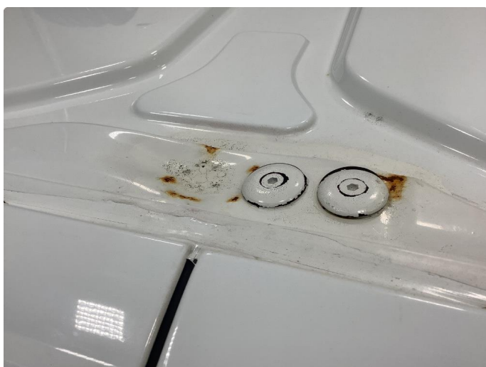
1.3 Bulk med lakk-skade tak, utbedres før salg.
