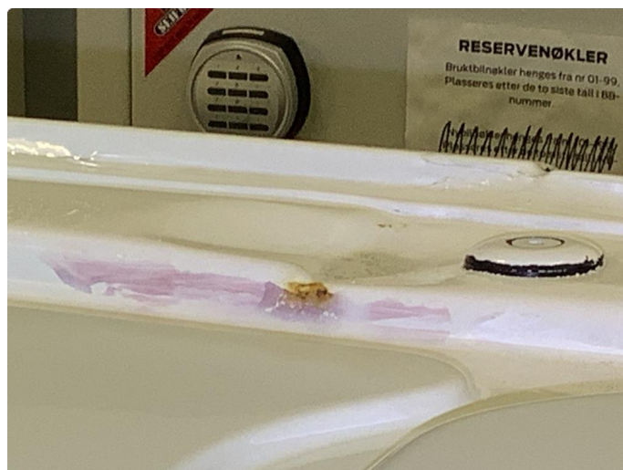
1.3 Bulk med lakk-skade tak, utbedres før salg.
