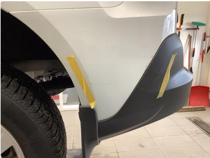
1.2 Noe riper støtfangervinge v.bak.
