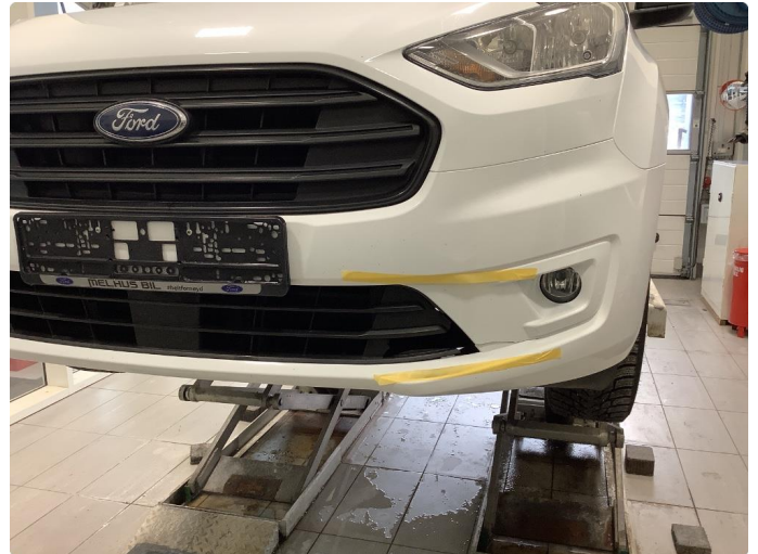
1.1 Skade v.side støtfanger foran
