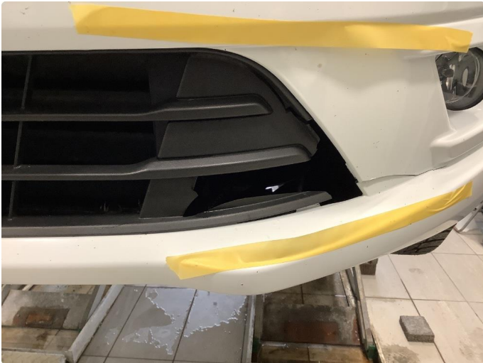
1.1 Skade v.side støtfanger foran
