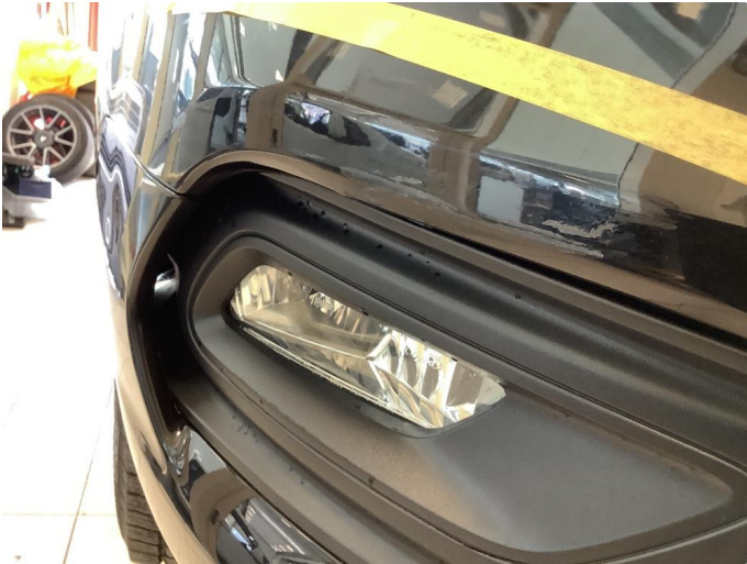
1.1 Noe lakk-skade støtfanger foran.
