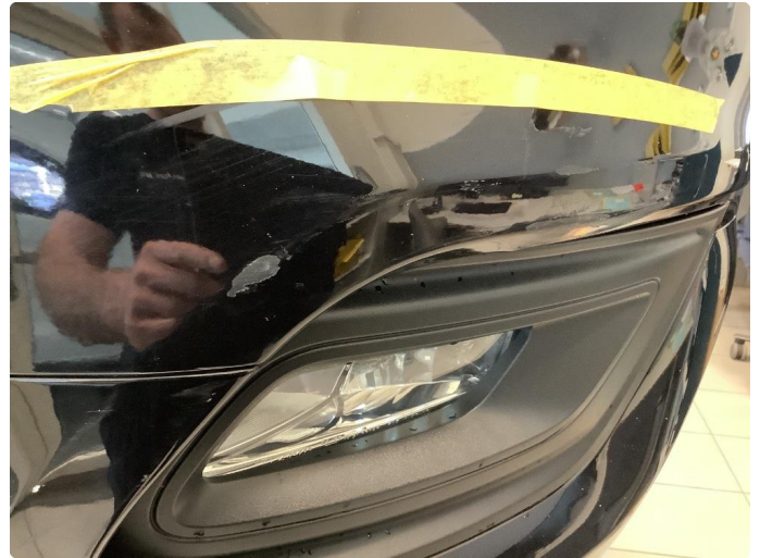
1.1 Noe lakk-skade støtfanger foran.
