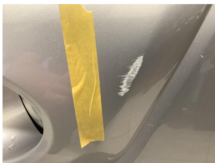
1.4 Noe riper støtfanger foran.
