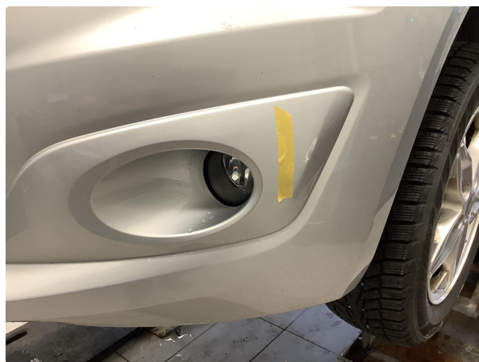
1.4 Noe riper støtfanger foran.
