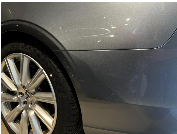
1.3 Lakkbobler/korrosjon mot støtfanger begge bakskjermer.
