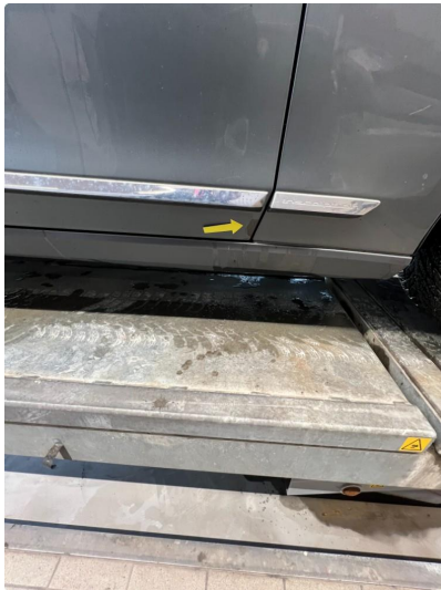
1.2 Lakk flasser framkant dør høyre foran.
