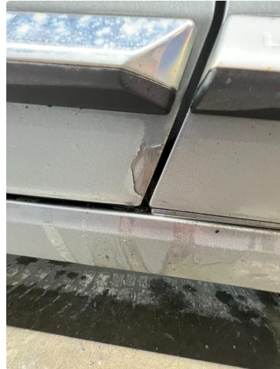
1.2 Lakk flasser framkant dør høyre foran.
