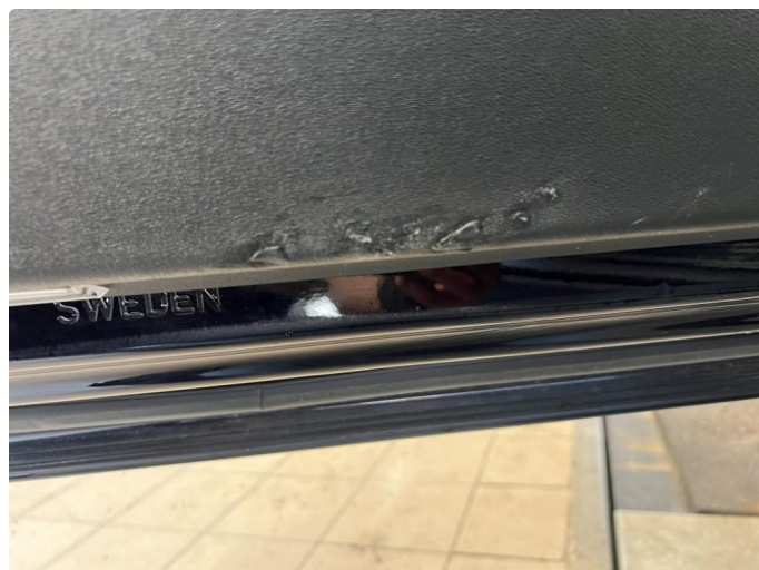
2.1 Skadet/merker dørtrekk venstre foran.
