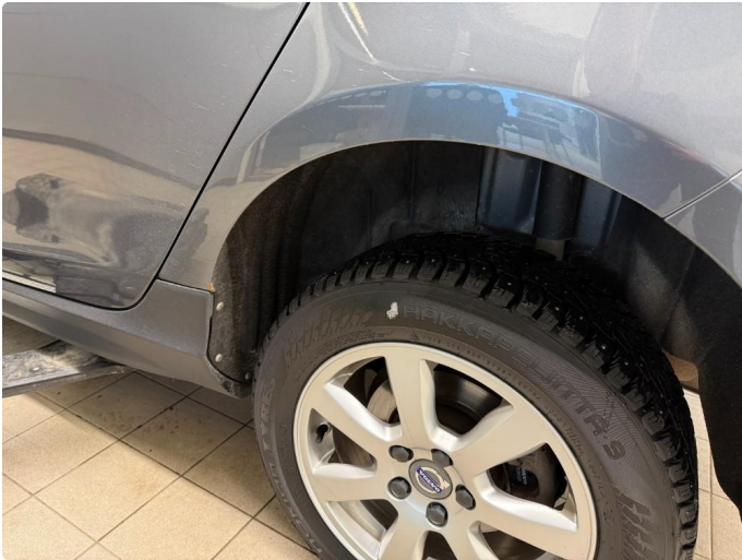
1.3 Korosjon hjulbue venstre bak.
