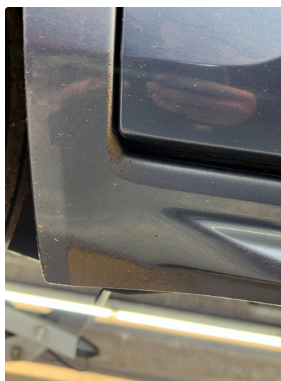
1.8 Slitt lakk bakkant kanaler.
