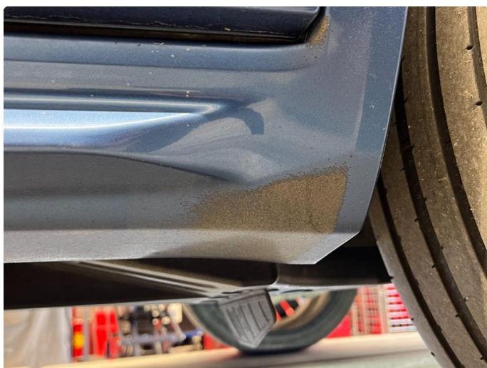
1.8 Slitt lakk bakkant kanaler.
