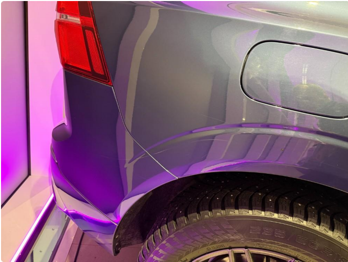
1.3 Riper skjerm og støtfangerhjørne høyre bak.
