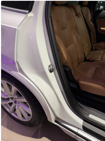
1.3 Flere små bulker døråpninger begge sider bak.
