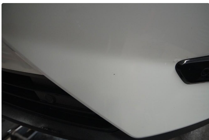
1.1 Noen små steinsprut støtfanger foran. Lakkert forenklet.
