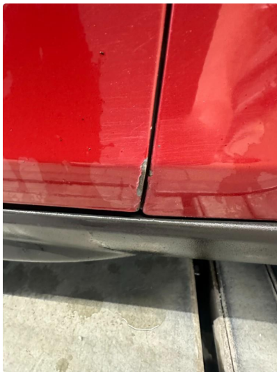
1.2 Korrosjon framkant mot skjerm begge framdører.
