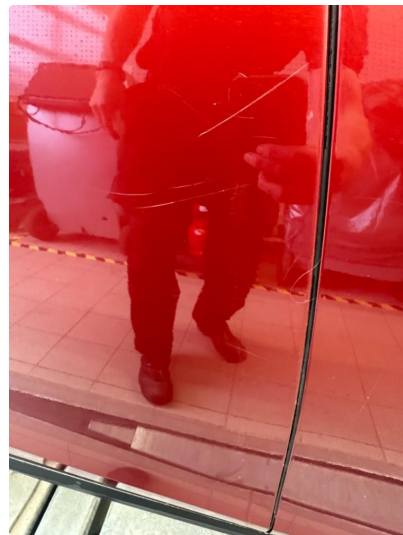
1.3 Riper framkant dør høyre bak.
