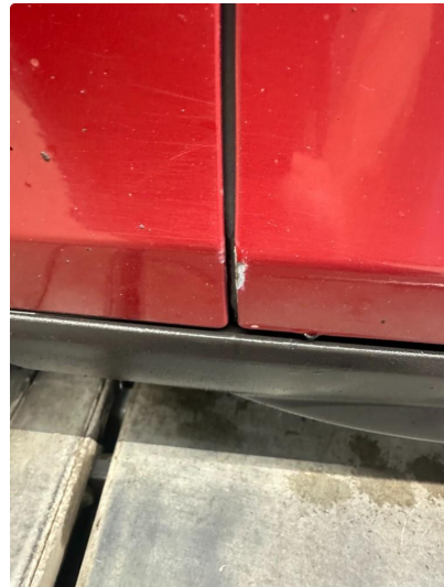
1.2 Korrosjon framkant mot skjerm begge framdører.
