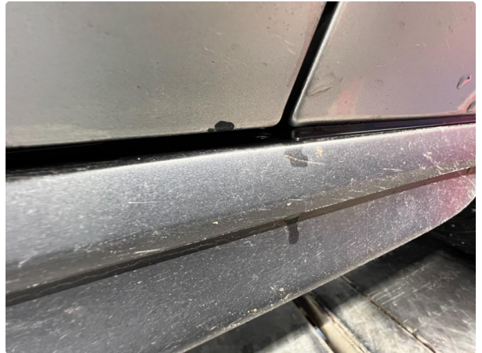
1.1 Korrosjon framdør høyre.
