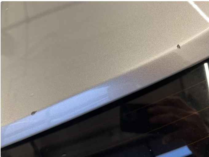
1.2 Ripe(r) ned til grunning
