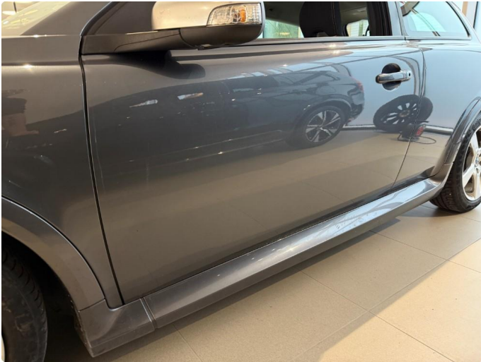
1.1 Flere småbulker under speil dør venstre.
