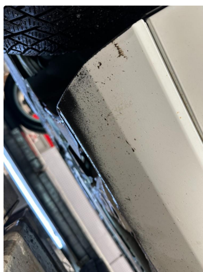
1.3 Slitt lakk begge sider kanal.
