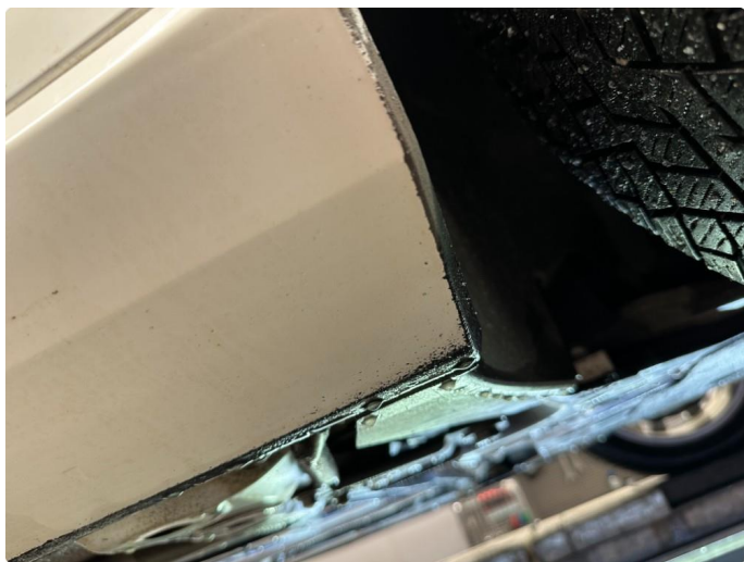
1.3 Slitt lakk begge sider kanal.
