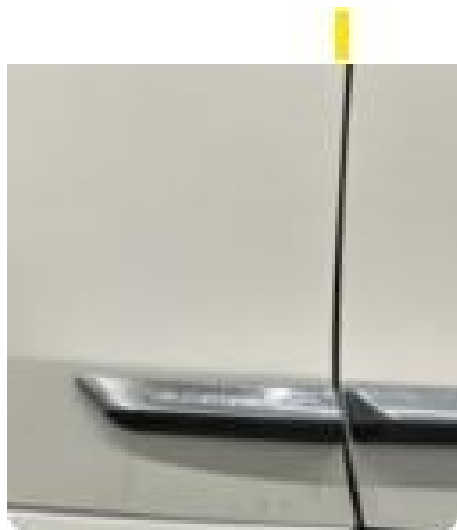
1.1 Hakk i lakk framkant under pyntelist begge framdører.
