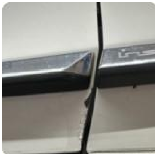
1.1 Hakk i lakk framkant under pyntelist begge framdører.
