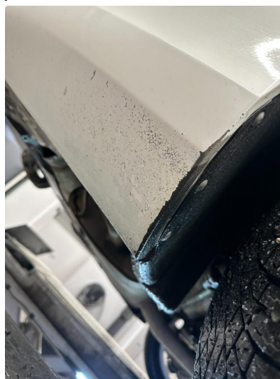
1.3 Slitt lakk begge sider kanal.
