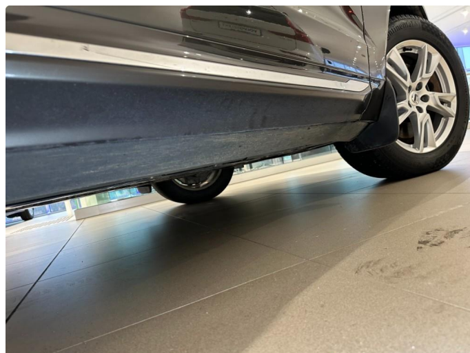
1.1 Slitt lakk nedre del av alle dører og dørstokk.
