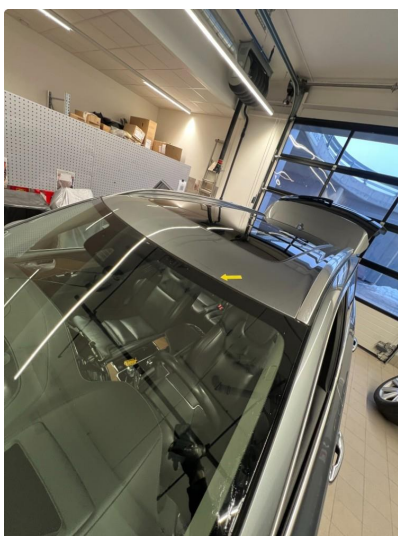
1.5 Korodert steinsprut framkant tak.
