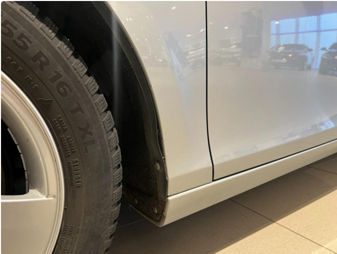
1.4 Korosjon hjulbuer etter steinsprut skjermer foran,
