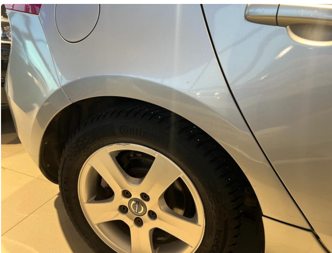
1.5 Flere små bulker og korosjon hjulbue skjerm høyre bak.
