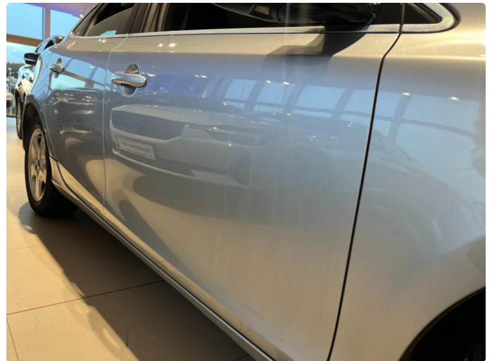
1.3 2 små bulker dør høyre foran.
