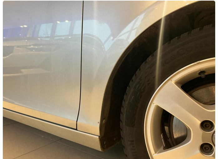
1.4 Korosjon hjulbuer etter steinsprut skjermer foran,
