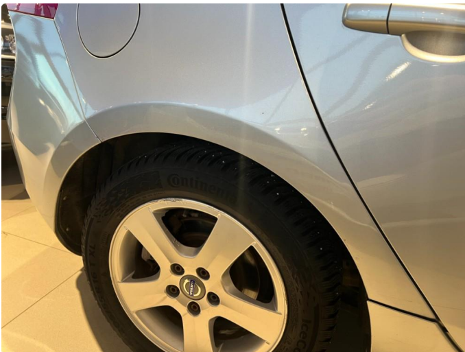
1.5 Flere små bulker og korosjon hjulbue skjerm høyre bak.
