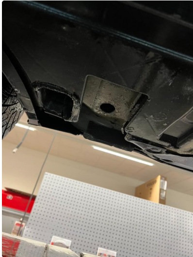
1.1 Mangler jekkfeste-deksel høyre foran.
