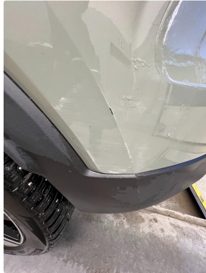
1.2 Riper støtfangerhjørne venstre og høyre bak.
