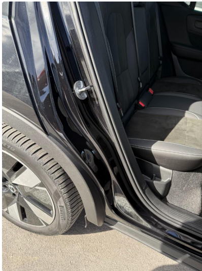
1.4 To små bulker døråpning høyre bak.
