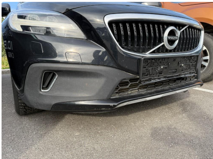
1.1 Riper nedre del støtfanger foran.
