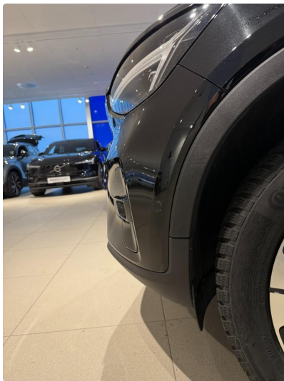
1.2 Noe steinsprang. Riper støtfangerhjørne/skjermutbygger venstre foran.
