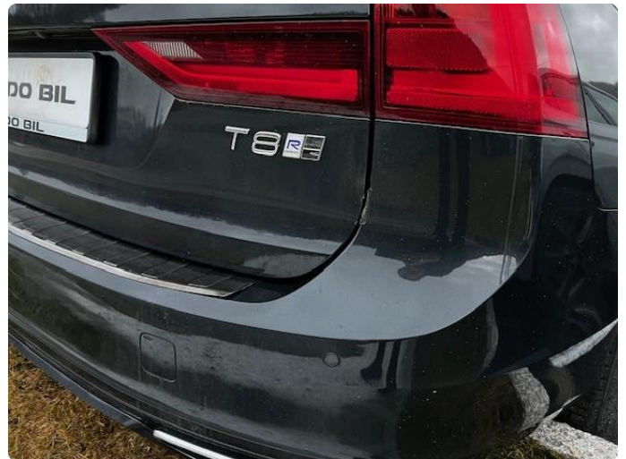
1.2 Hakk i støtfanger ved bakluke.
