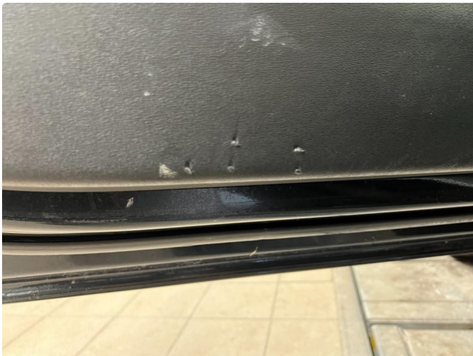
2.1 Små hakk i dørtrekk førerdør.
