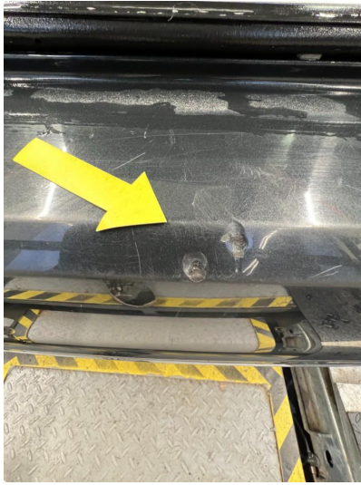
1.3 Riper/hakk støtfanger bak.
