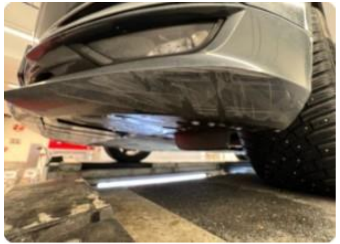
1.4 Skrubbskader underkant støtfanger foran.
