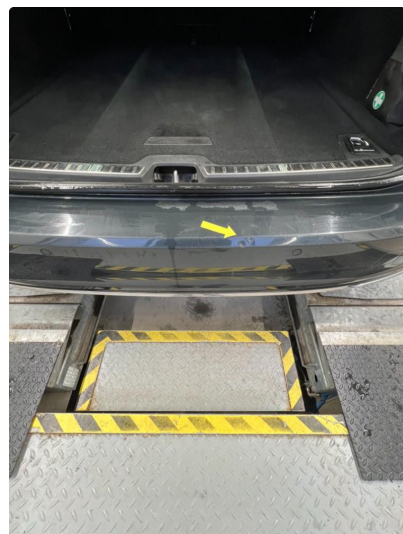
1.3 Riper/hakk støtfanger bak.
