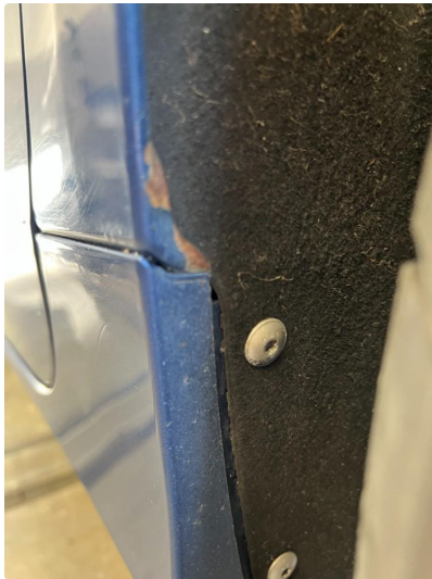
1.2 Korrodert steinsprut hjulbuer foran.
