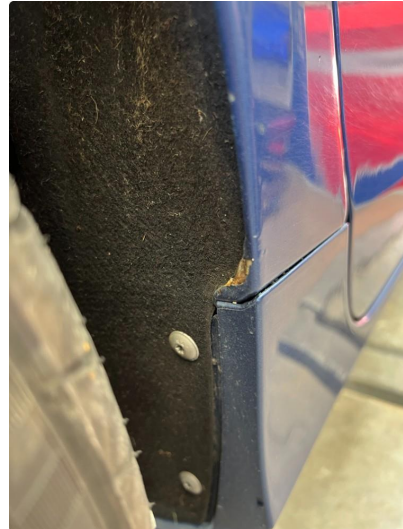
1.2 Korrodert steinsprut hjulbuer foran.
