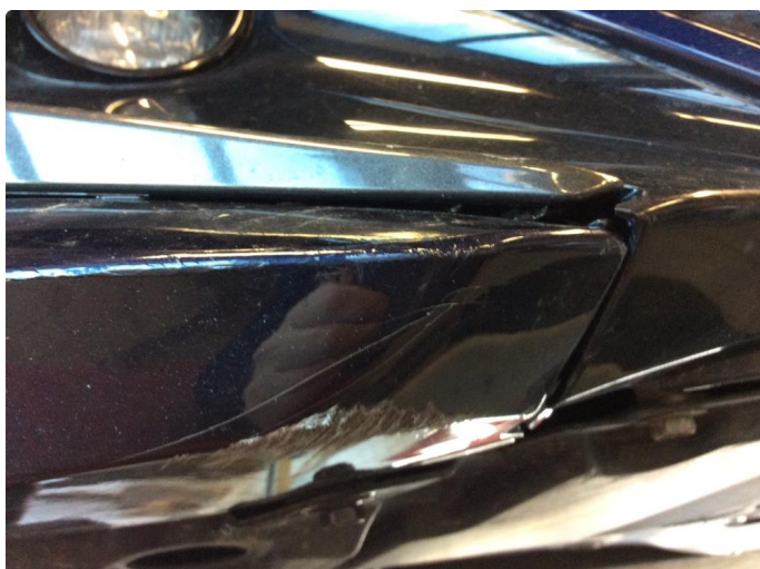
1.2 Liten skade front fanger h side nede
