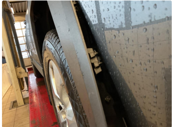
1.2 List til skjerm / støtfanger foran er knekt i feste h side foran
